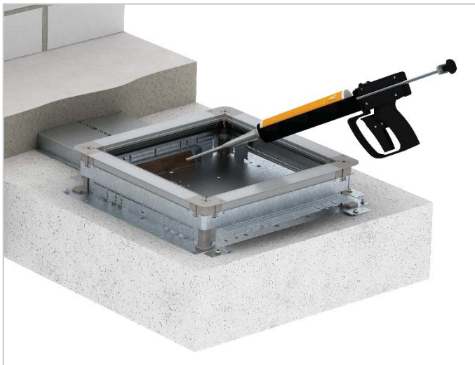
Bild 2: Einbringen des Brandschutzschaums in den Kanal
