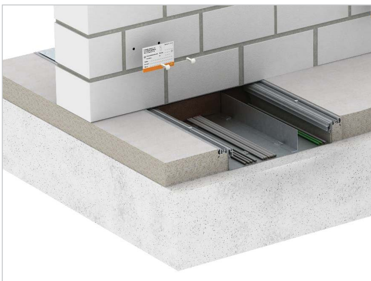
Bild 2: Abschottungsmaßnahme im Bereich der Wandquerung
