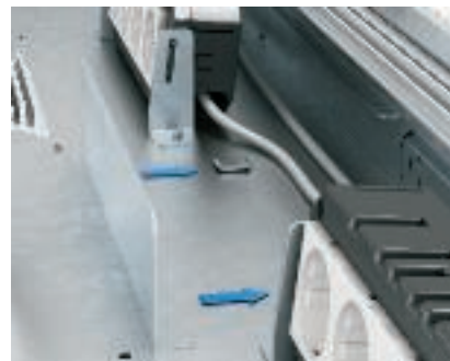
Montaż przegród Przegrody należy wstawić dopiero po montażu okablowanych puszek instalacyjnych i wsporników montażowych.
