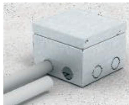
Podłączenie peszli Doprowadzić peszel M25, schować maks. na 5 mm.
