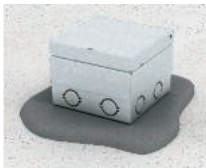
Dopasowanie do wysokości wylewki Jeżeli wysokość wylewki przekracza 95 mm, należy wykonać warstwę wyrównawczą pod kasetą zasilającą.
