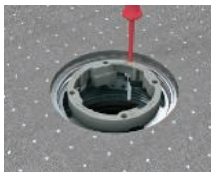
Montaż puszki napodłogowej Telitank na wyjściu podpodłogowym US80 i puszcze podpodłogowej UDL2-80 Znajdujący się wewnątrz pierścienia montażowy należy wkręcić w górną część wyjścia i ustawić przez przykręcenie śruby naprężającej. Włożony pierścień dystansowy powinien znajdować się na poziomie górnej krawędzi gotowej podłogi.
