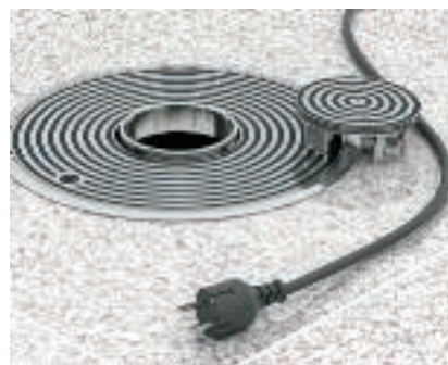
Doprowadzenie przewodów Przewody odbiorników są wsuwane i wtykane do zainstalowanych gniazd przez otwarty tubus po podniesieniu pokrywy. Następnie tubus jest opuszczony i blokowany w profilu.
