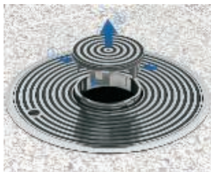
Otwieranie tubusa Cztery wsporniki blokują pokrywę w profilu tubusa, wystarczy nacisnąć dwa do jego uwolnienia
