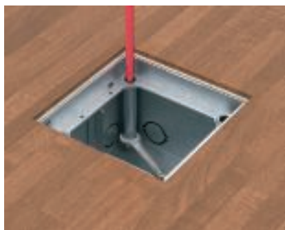
Ustawianie do wysokości górnej krawędzi gotowej podłogi Ustawić i wyregulować wysokość a następnie dokręcić śruby regulujące nakrętką zabezpieczającą.
