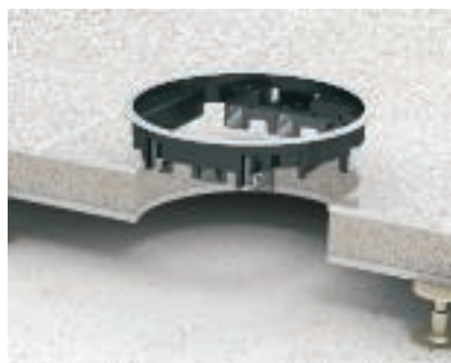
Montaż w podłogach podwójnych i technicznych W przypadku montażu w podłogach podwójnych i technicznych uniwersalny uchwyt montażowy zachowuje się jak rozpórka zębata. Dokręcić śruby maksymalnie 4 obrotami. Zębátka mocuje kasetę zasilającą w otworze montażowym.
