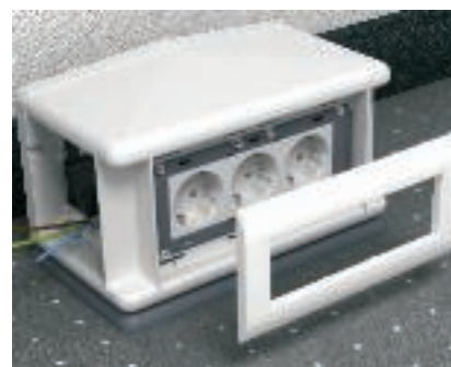
Montaż osprzętu elektroinstalacyjnego Modul 45® z ramkami S990 w T4L i T8NL Przygotować otwory na przewody w puszkach napodłogowych T4L. Przed podłączeniem przewodu zatrzasknąć osprzęt elektroinstalacyjny Modul 45® w ramce montażowej. Ramkę S990 zatrzasknąć od zewnątrz w obudowie.
