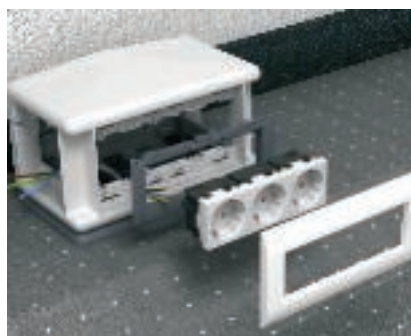
Montaż osprzętu elektroinstalacyjnego Modul 45® w T4L i T8NL Przygotować otwory na przewody w puszkach napodłogowych T4L. Przed podłączeniem przewodu zatrzasknąć osprzęt elektroinstalacyjny Modul 45® w ramce montażowej.
