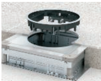
Montaż w systemie kanałów Kasetę zasilającą włożyć od góry do pokrywy montażowej i przykręcić. Uchwyt montażowy sięga poniżej pokrywy montażowej.
