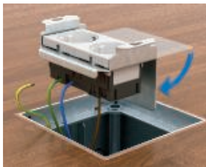
Montaż gniazda zasilającego w wsporniku Zatrzasnąć gniazdo zasilające w metalowym wsporniku i podłączyć. Po podłączeniu przewodu PE wygiąć metalowy wspornik o 90°.
