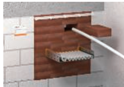
Łatwa późniejsza instalacja przez wyjęcie pojedynczych bloczków
