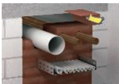
Prowadzenie rur palnych bez dodatkowych materiałów
