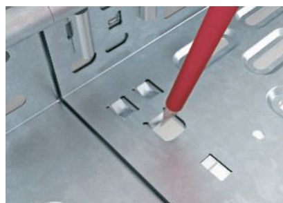
Bezśrubowy łącznik, wystarczy wygiąć blaszki zabezpieczające w dnie
