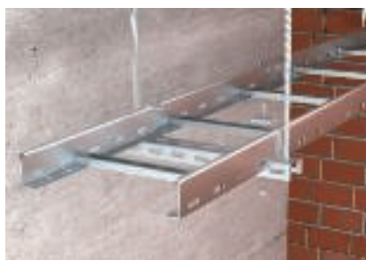
Montaż na profilu poprzecznym za pomocą zacisku, śrub z łbem grzybkowym i dużych podkładek
