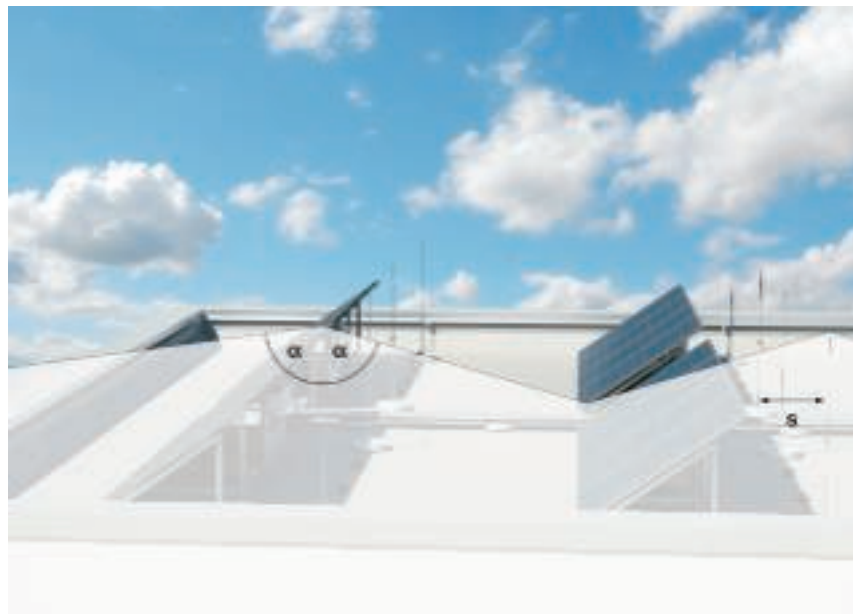
\alpha^\circ = Kąt ochronny, s = Odstęp separacyjny
