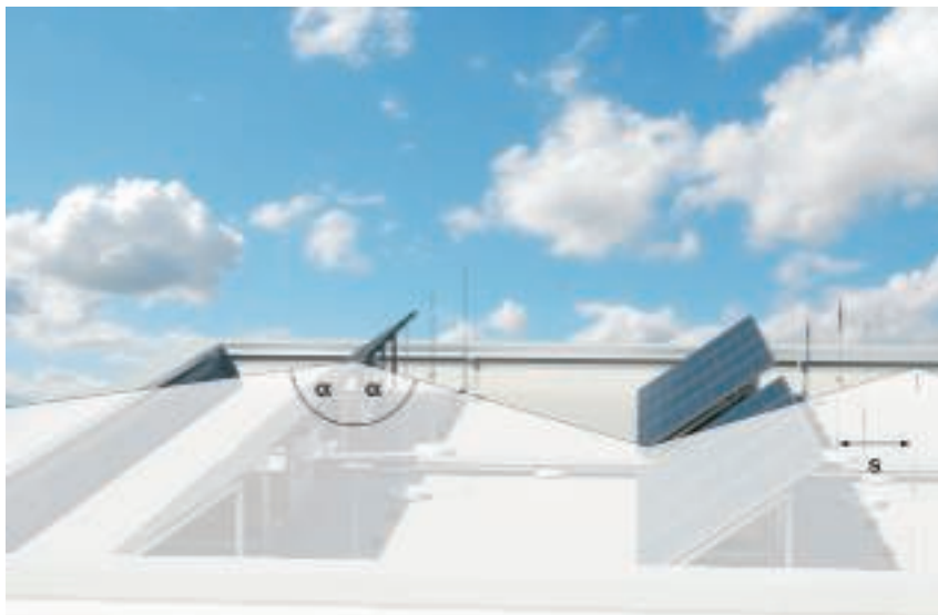
\alpha^\circ = Kąt ochronny, s = Odstęp separacyjny
